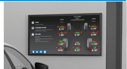
Un rapport automatique détaille les éventuelles perturbations de la conduite causées par des mesures hors spécifications et les ajustements nécessaires. L'audit devient ainsi un outil efficace pour proposer le service d'ajustement.
