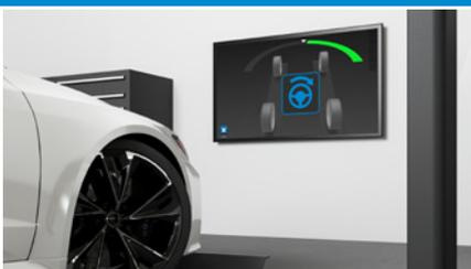
La medición de la incidencia se acelera gracias a las plataformas giratorias automáticas (opcionales), que se desbloquean automáticamente.
