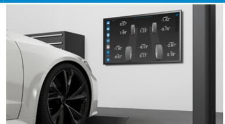
En sólo 5 segundos, el sistema mide la convergencia y la inclinación sin necesidad de desmontar la llanta, lo que acelera aún más el proceso.
