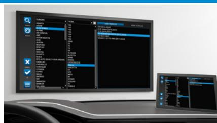
La preselección automática, basada en las dimensiones del vehículo ya detectadas, filtra la lista de modelos, agilizando la selección de las especificaciones técnicas.
