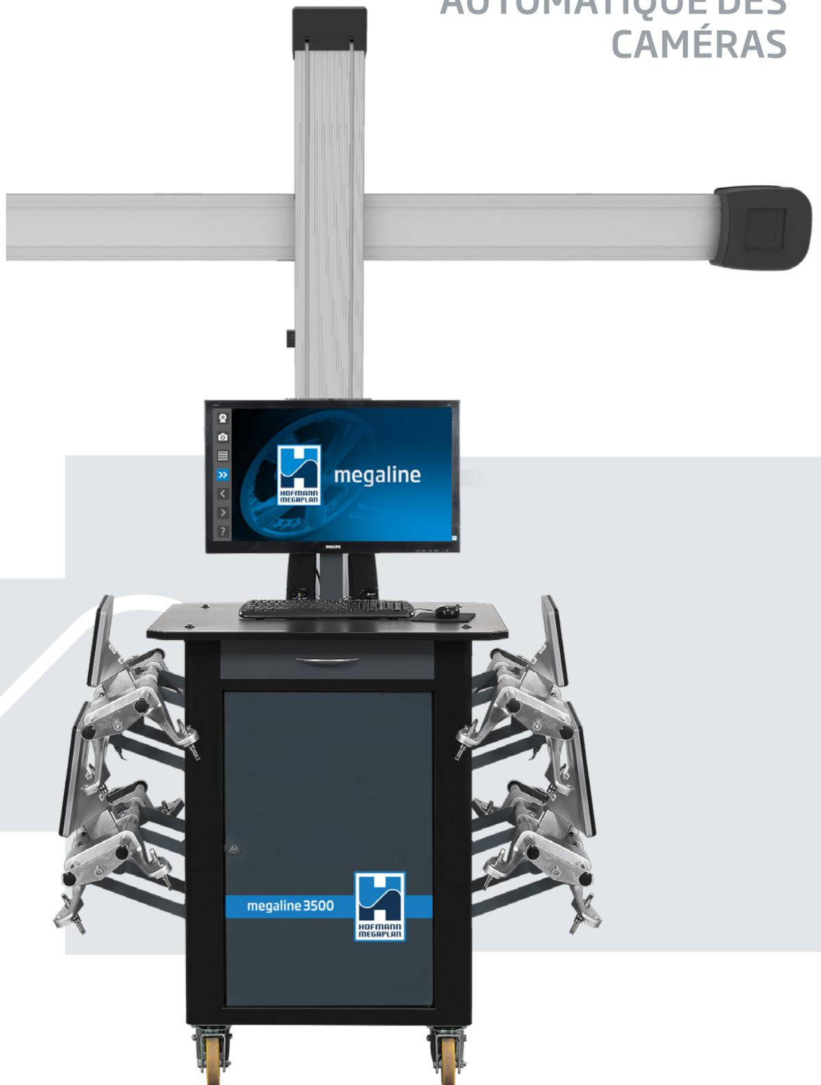
La vaste gamme d'assiettes de roue proposée par Hofmann Megaplan représente une solution efficace pour la mesure de l'assiette de voitures et de poids lourds. Les systèmes d'alignement de roues Hofmann Megaplan sont hautement technologiques et produisent rapidement des résultats extrêmement précis et fiables.
