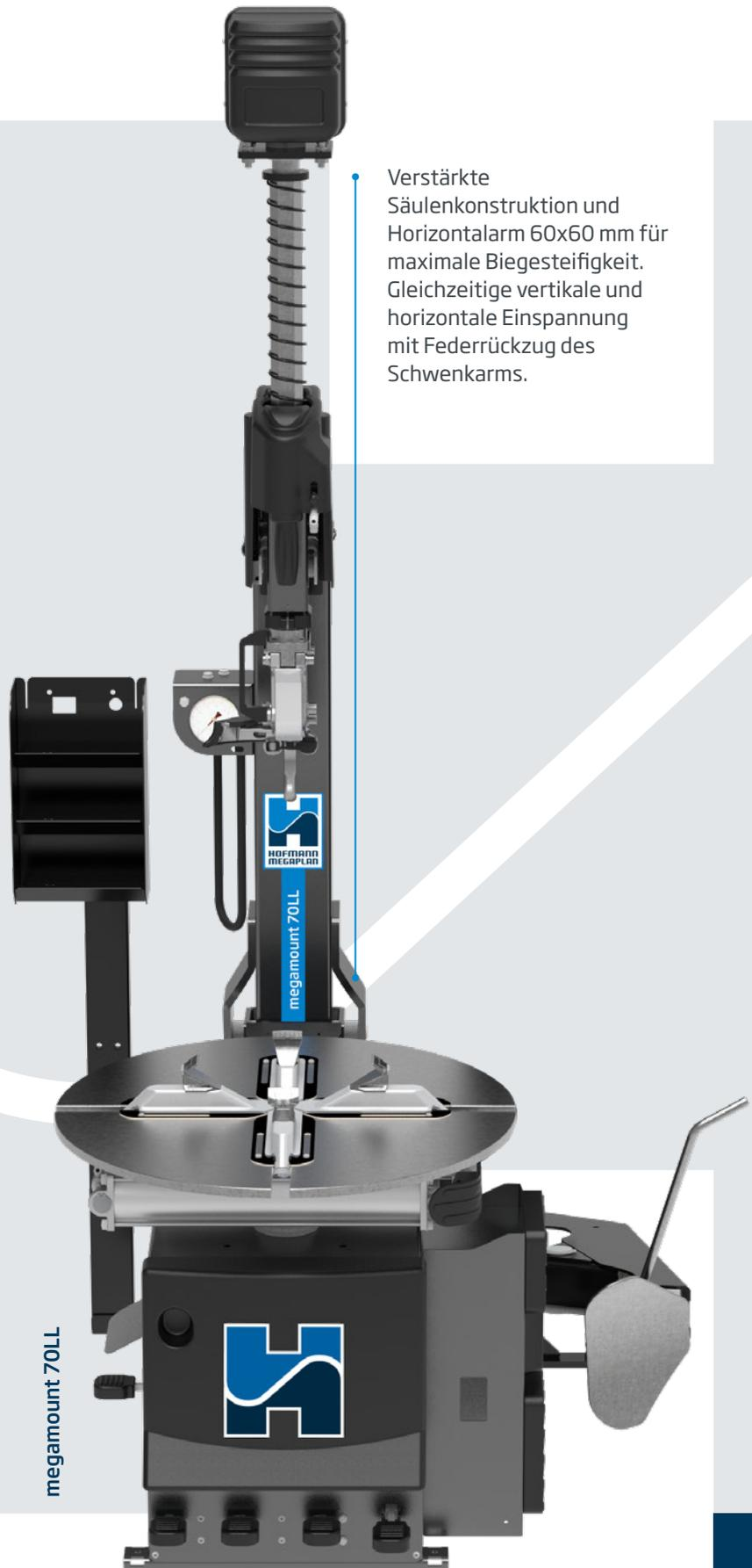
Verstärkte Säulenkonstruktion und Horizontalarm 60x60 mm für maximale Biegesteifigkeit. Gleichzeitige vertikale und horizontale Einspannung mit Federrückzug des Schwenkarms.
