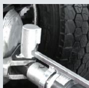
Cylindre LL pour démontage sans levier
